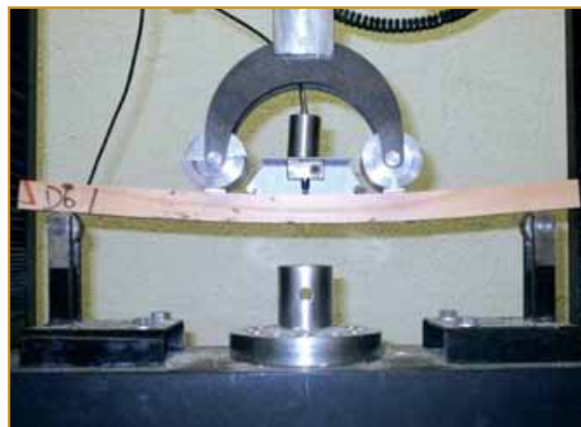
Essais de flexion 4 points sur éprouvettes de petites et grandes dimensions.
