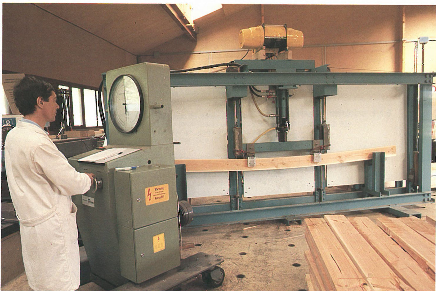
Essais de qualification sur bois en dimensions commerciales.
