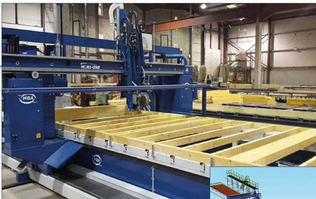
CADREUSE CLOUEUSE MOBI ONE JJ SMITH Cap. 12m x 4m
